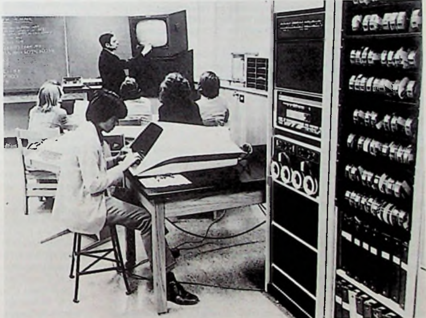
Voor onderwijsdoeleinden heeft Digital Equipment Corp. het programma computers met een drietal typen uitgebreid. Het Edu System 5, opgebouwd rond een minicomputer PDP-S/F met 4K geheugen en ASR-33 telex, in BASIC te programmeren is met een prijs van f 22 810 het goedkoopste. Het Edu Systeem-15 beschikt daarnaast nog over een DECTape-geheugen met een capaciteit van 370 000 woorden per haspel. Het Edu-system-25, zoals hier afgebeeld, heeft een 12K magneetkerngeheugen en beschikt over een beeldstation.
